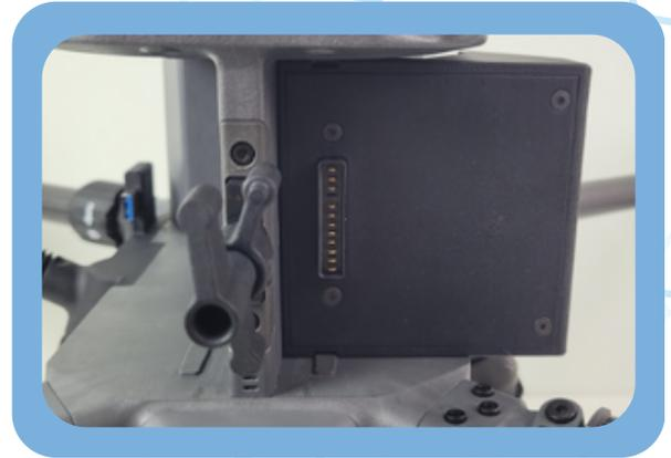
Rentrer le module dans le bon sens dans l'emplacement batterie ( il y a un rail pour faire coulisser le module )
