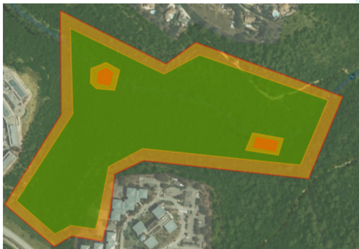
Fig.10: Exemple 1, fence complète valide avec NFZ.
