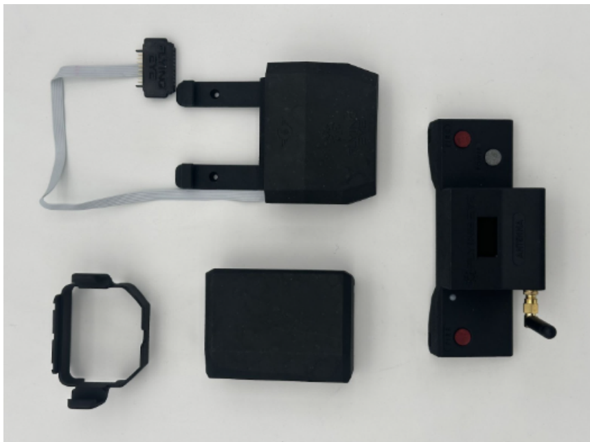
Fig.1: Composant du système FTS/Parachute avec Geofencing pour le Matrice 3 (version 1).
