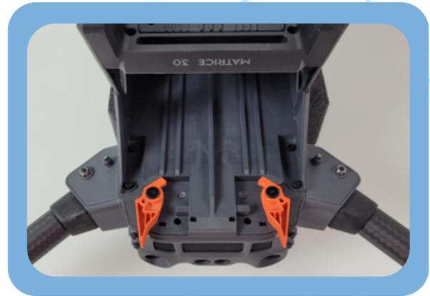
Retourner le drone et le poser sur une surface souple
