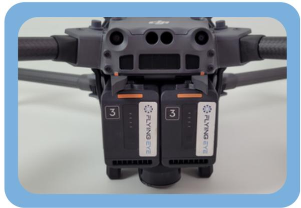
Mettre les batteries et fermer les loquets
