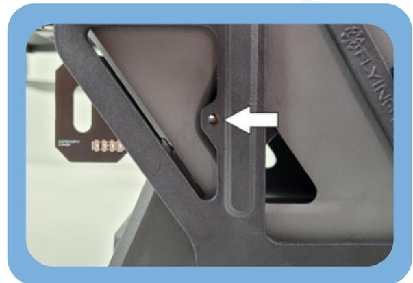
Visser avec la vis M3 x8 dans leurs emplacements de chaque côté du châssis
