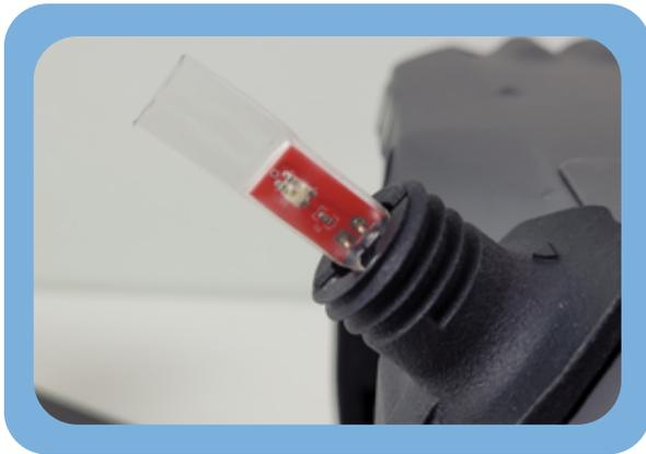
Retirez les Leds Test
