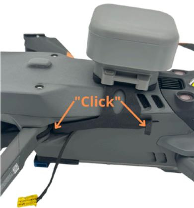
Pivotez le légèrement afin de « clipser » le support dans les orifices du drone.
