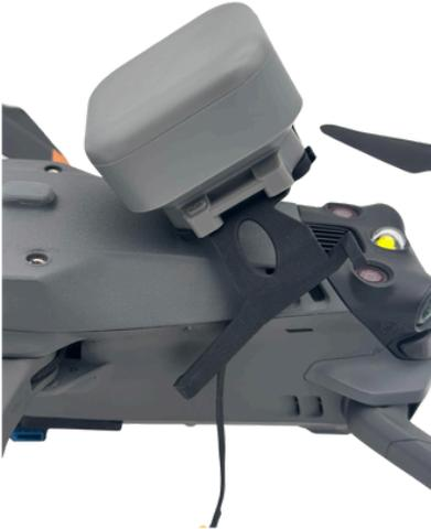
Insérez le parachute sur le drone
