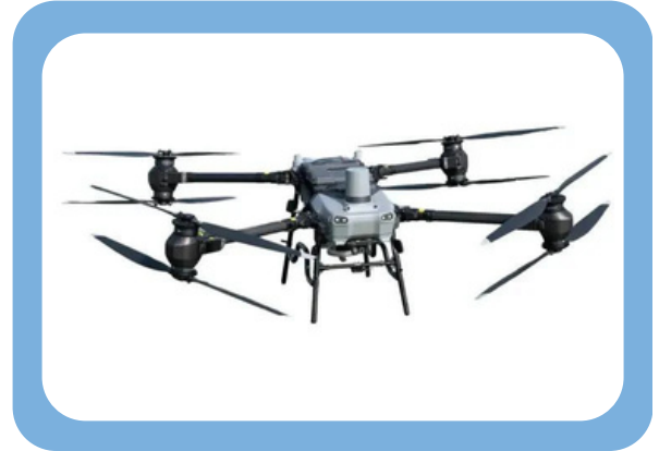
Déplier les bras du drone, puis les hélices
