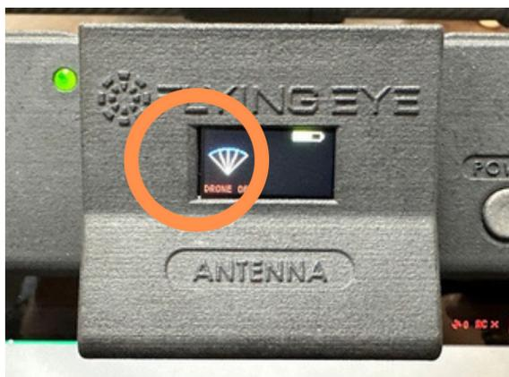
Ce symbole apparaît, les moteurs se coupent, les LEDs s'allument et le buzzer sonne. Retirez ensuite la batterie du drone pour arrêter le système
