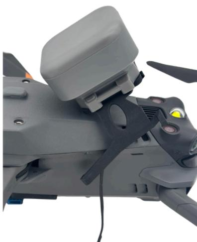
1. Insérer le parachute sur le drone
