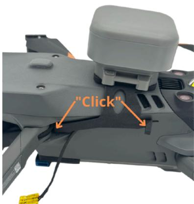
2. Pivoter le légèrement afin de « clipser » le support dans les orifices du drone.
